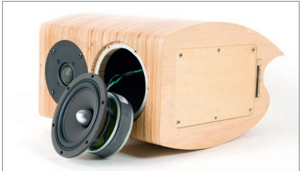
Bassoelementti on peräisin Seasin Excel-sarjasta ja kokoisekseen hyvin järeä. Magneetti on lähes kotelossa olevan asennusaukon kokoinen. Diskanttina on saman valmistajan 27-millinen tekstiilikalotti.
